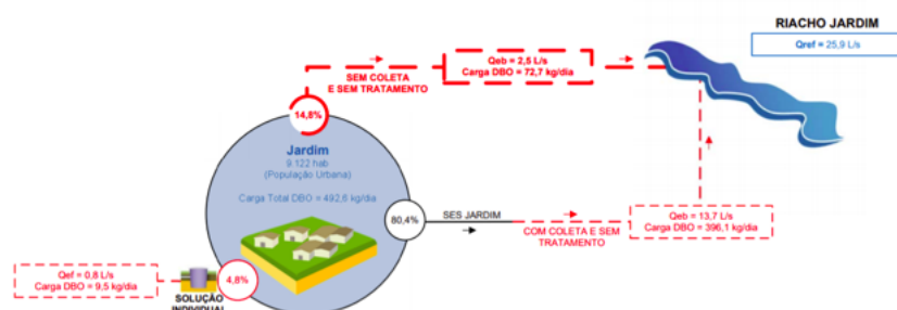
Imagem 02: Esgotamento Sanitário em Jardim/CE
