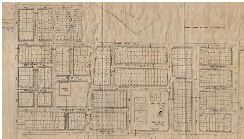
Figura 02 - Partido Urbanístico do Abolição I digitalizado e vetorizado na plataforma AutoCad (abaixo)
